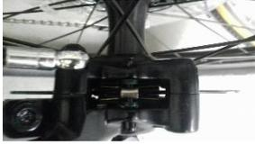
An einer hydraulischen Scheibenbremse wirkt auf jeden Bremsbelag eine Normalkraft von 4700 N. Der Reibungskoeffizient beträgt 0,35. Wie groß ist die Bremskraft (Reibkraft)?
