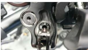
Der Geberkolben einer hydraulischen Felgenbremse hat einen Durchmesser von 11 mm. Auf den Kolben wirkt eine Kraft von 1200 N. Welcher Druck wird dadurch im Bremssystem erzeugt?
