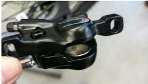
Der Druck an einer hydraulischen Scheibenbremse beträgt 140 bar. Der Durchmesser des Radbremskolbens beträgt 21 mm. Wie groß ist die Normalkraft, die auf den Bremsbelag wirkt?
